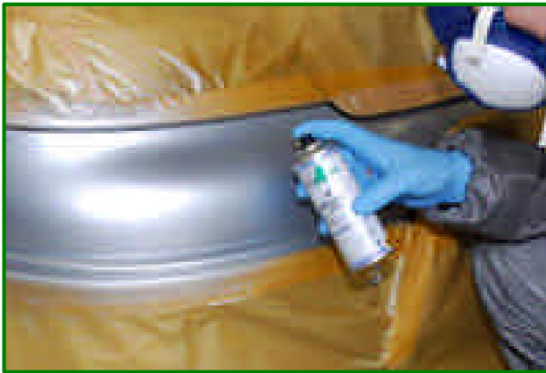
Klarlack in 1-2 Spritzgängen lackieren
