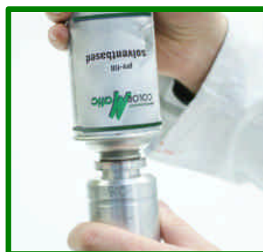
Step 9: Tür öffnen, befüllte Dose herausnehmen und den Zylinder über Kopf von der Dose nehmen. CleanJector aus dem sauberen Abfüllzylinder ziehen.
