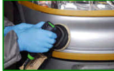
Schleifen mit P180 – P500 / Mattieren der Randzone mit P2000 – P4000
