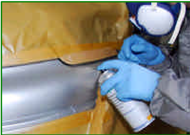
Spotblender in die Randzone einlackieren
