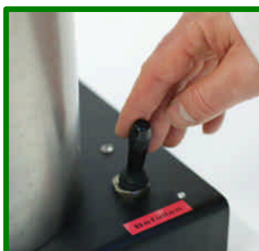
Step 10: Tür schließen und mit Umlagen des Hebels wird der Befüllvorgang ausgelöst.
