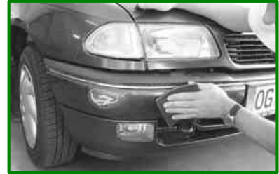
Schleifen mit P180 – P500 / Mattieren der Randzone mit P2000 – P4000
