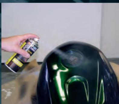
6. Für lang anhaltenden Glanz, verbesserte Witterungsbeständigkeit und Schutz vor mechanischen Belastungen wird abschließend mit DUPLI-COLOR Schutzklarlack die lackierte Fläche versiegelt.
