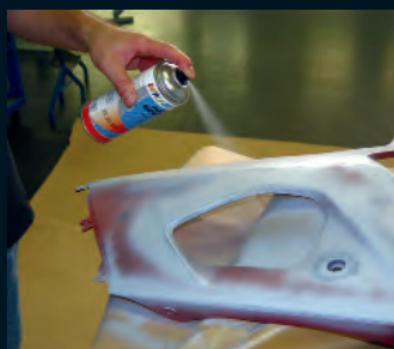
3. Anschließend die Flächen mit der DUPLI-COLOR Kunststoff-Grundierung vorlackieren, um die Haftung für nachfolgende Lackschichten zu optimieren. 20 Min. trocknen lassen.
