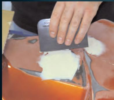
2. Vorhandene Löcher, Kratzer und Dellen werden mit presto Füllspachtel bearbeitet und ca. 30 Min. später die Überstände zu einer planen Fläche abgeschliffen.
