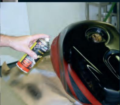
5. Den FLIP FLOP-Effekt anschließend in mehreren dünnen Schichten lackieren. Dabei jeweils kurze Trocknungszeiten von 5-8 Min. einhalten.
