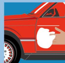
Nach kurzer Anrocknungszeit mit Watte oder einem weichen Tuch auf Hochglanz polieren.
