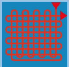
Mehrere, dünne Schichten aufsprühen bis eine glänzende, geschlossene Lackschicht entsteht. Großflächige Ausbesserungen im Kreuzgang-Verfahren
