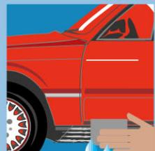
Schadstelle gründlich reinigen und mit Schleifpapier (600er Körnung) naß anschleifen.
