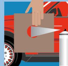
Bei Metallic-Lackierungen nach circa 30 Min. Trockenzeit unbedingt mit 2-Schicht-Klarlack übersprühen
