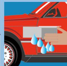
Mit Wasserschleifpapier (800-1000-er Körnung) fein nachschleifen
