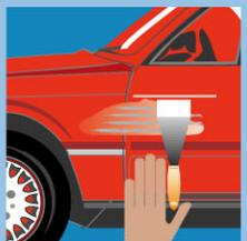
Blankes Blech mit 1 K Korrosionsschutz grundieren, anschließend mit Spachtel oder Spritz-Spachtel auffüllen.
