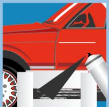
Nach Trocknung DUPLI-COLOR Autospray mehrfach in dünnen Schichten aufsprühen.
