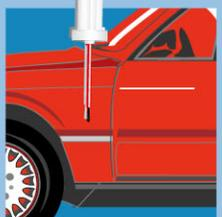
Lack in mehreren dünnen Schichten auftragen
